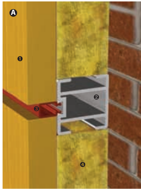
Sección vertical travesaño. 1. _Tablero 16 mm. 2. _Travesaño. 3. _Entrecalle: lambeta. 4. _Lana de roca aislante (opcional).
