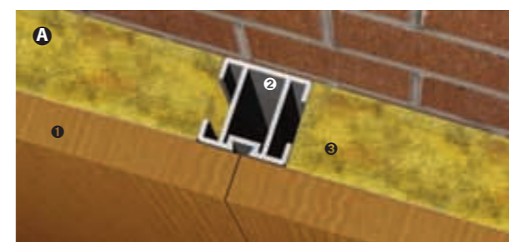
Sección horizontal pie con tablero a testa.
