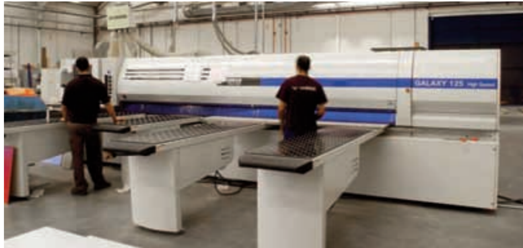
Seccionadora de tableros automática con carga trasera.
