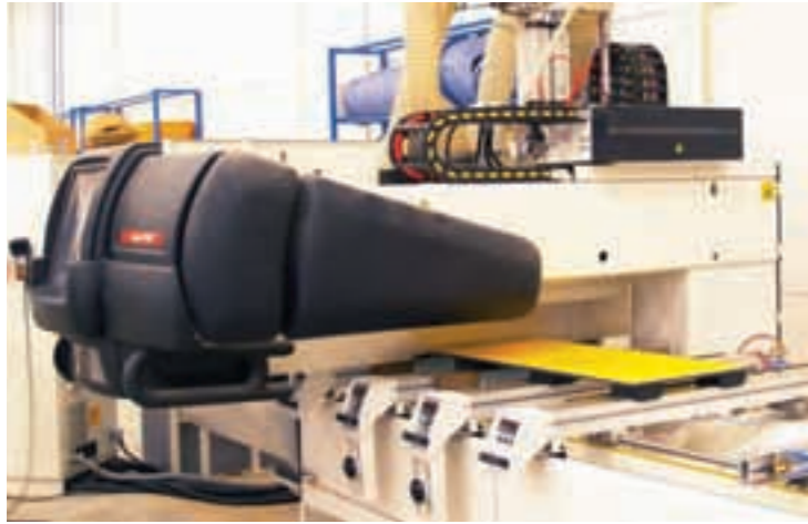
Centro de mecanizado automático para producción personalizada pieza a pieza.
