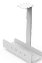
El **porta CPU** es un producto fabricado en chapa de acero laminado en frío con **1.5 mm** de espesor. Regulable en anchura (210 mm - 150 mm) con un sistema de ranuras y fijación mediante tornillos.
