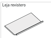
2 Leja revistero: Chapa de acero plegada de espesor 0,8 mm y dimensiones 88 x 36 cm
