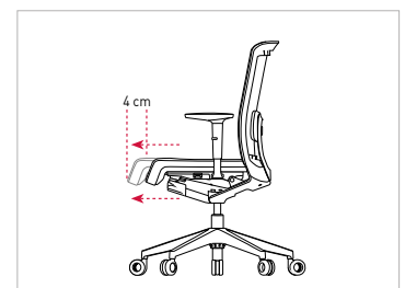
Bloqueo en 5 posiciones. Auto-retorno pulsando la maneta y levantándose del asiento.
