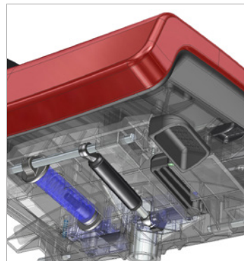
El pistón controla la velocidad del retorno del respaldo
