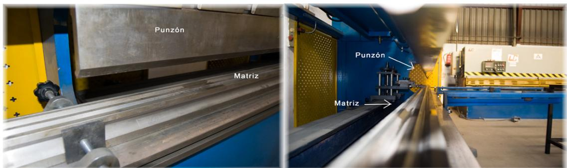
A consecuencia del doblado, se produce un estado de tracción-compresión, que tenderá a una pequeña recuperación elástica. Por ello el doblado se realiza a altas presiones, para evitar esta recuperación elástica, y que las piezas tengan el menor error posible en sus ángulos.
