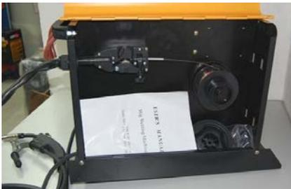
Estructura metálica o cuerpo, recubierta con pintura epoxi de secado al horno, y provista de regulación interior. Soldadas con soldaduras de resistencia eléctrica, en su modalidad de hilo continuo, lo que confiere una gran robustez.
