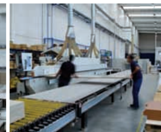
Canteadora recta unilateral para fabricaciones a medida.
