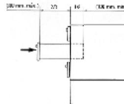
Ensayo 6. **Dispositivo antivuelco** UNE-EN 14074:04 Apdo. 6.2.4
