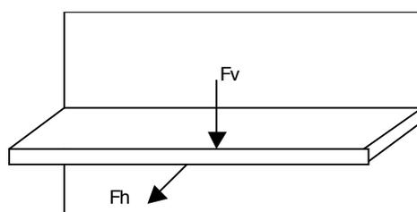
Ensayo 2. **Resistencia de los soportes de estantes** UNE-EN 14073-3:05 Apdo. 5.3.2
