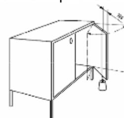
Ensayo 8. **Apertura y cierre brusco de puertas correderas y persianas de deslizamiento horizontal** UNE-EN 14074:04 Apdo. 6.4.2
