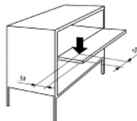
Ensayo 10. **Unidades apoyadas en el suelo con anclaje a la pared.** UNE-EN 14073-3:05 Apdo. 5.7
