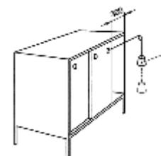
Ensayo 9. **Resistencia de las tapas abatibles** UNE-EN 14074:04 Apdo. 6.6.1
