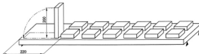
Ensayo 3. **Resistencia de las tapas superiores** UNE-EN 14073-3:05 Apdo. 5.4
